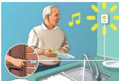
Türklingelverstärker mit visuellem Signal für Schwerhörige
